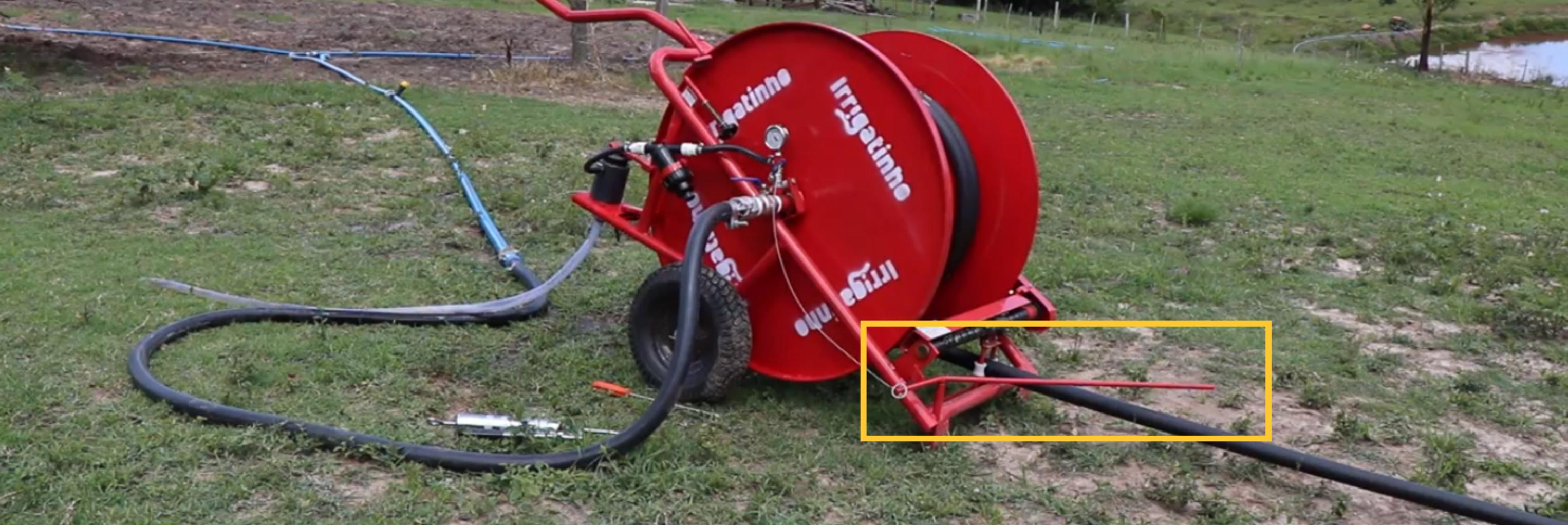
Ao final do processo de **irrigação**, o sistema efetua o **desligamento automático** através de **uma haste** e o carretel para de recolher. Assim, o **produtor rural** não precisa se preocupar em ficar ao lado do carretel ou esperando até que a lavoura seja irrigada para desligar o equipamento.
