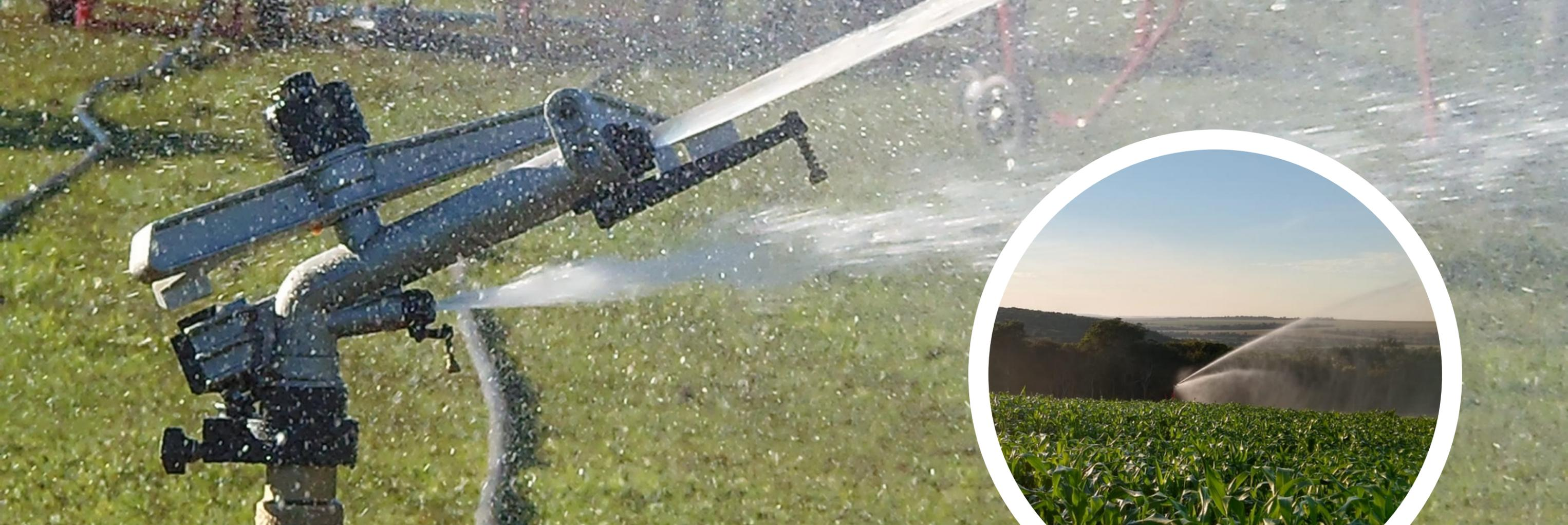
Essa técnica **simula uma chuva artificial**, onde um aspersor expelle água para o ar que se transforma em pequenas gotículas de água, caindo sobre o solo e sobre as plantas. Seus principais sistemas são a **convencional**, **pivô central** e o **autopropelido**.
